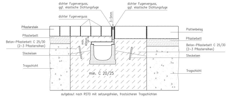
aufgebaut nach RSTO mit setzungsfreien, frostsicheren Tragschichten
