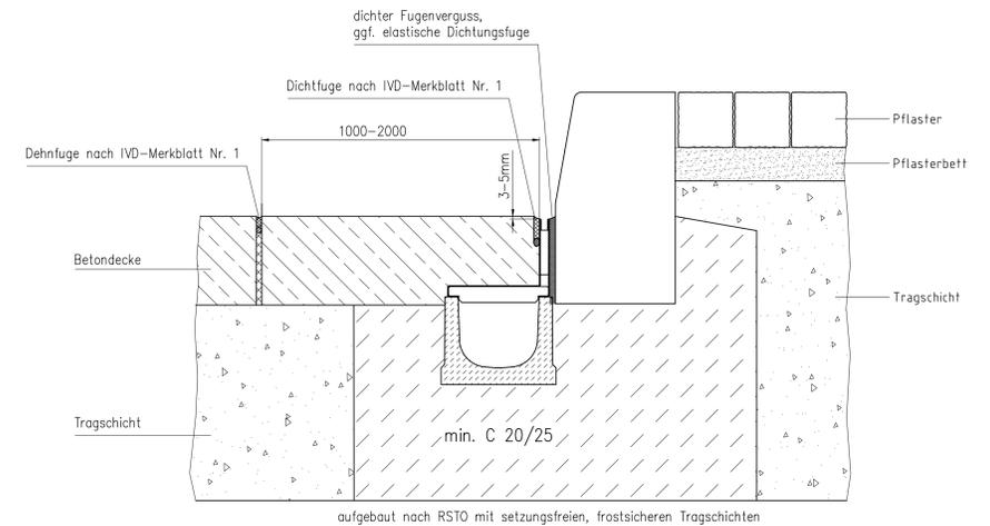
aufgebaut nach RSTO mit setzungsfreien, frostsicheren Tragschichten
