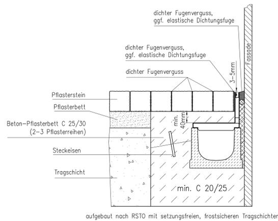
aufgebaut nach RSTO mit setzungsfreien, frostsicheren Tragschichten
