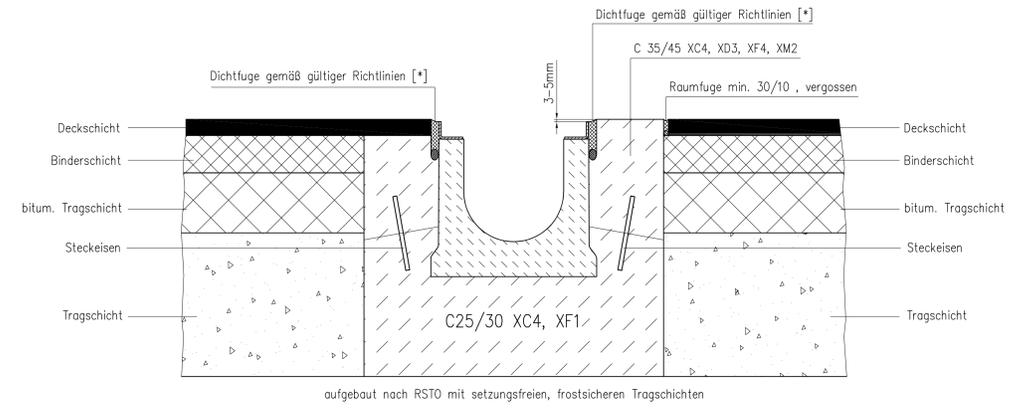
aufgebaut nach RSTO mit setzungsfreien, frostsicheren Tragschichten
