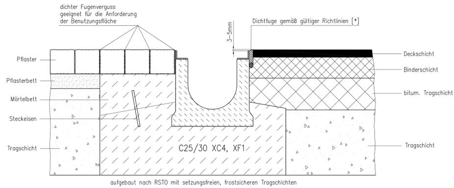
aufgebaut nach RSTO mit setzungsfreien, frostsicheren Tragschichten
