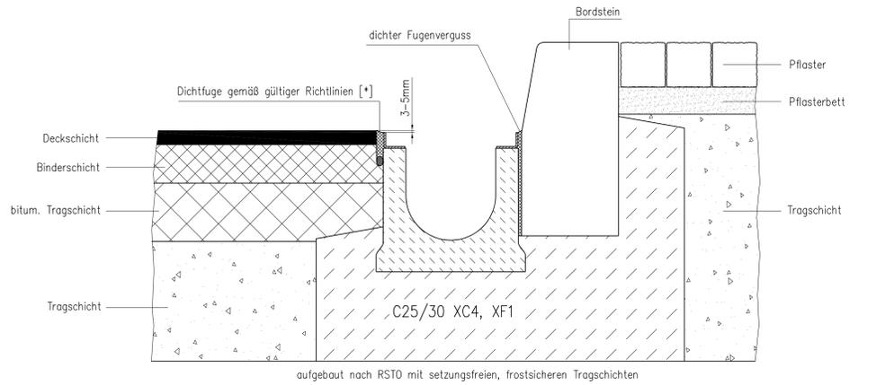
aufgebaut nach RSTO mit setzungsfreien, frostsicheren Tragschichten
