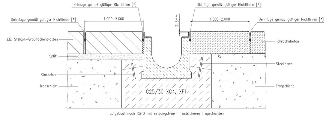
aufgebaut nach RSTO mit setzungsfreien, frostsicheren Tragschichten
