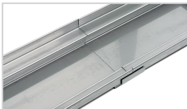
Bei erhöhten Anforderungen an die Dichtigkeit empfehlen wir die Rinnenstöße zu verschweißen und die Arbeitsfugen entsprechend abzudichten.
