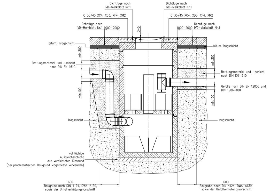
Die Tragschichten müssen frostsicher und gemäß RSTO (aktuelle Ausgabe) ausgeführt werden.
