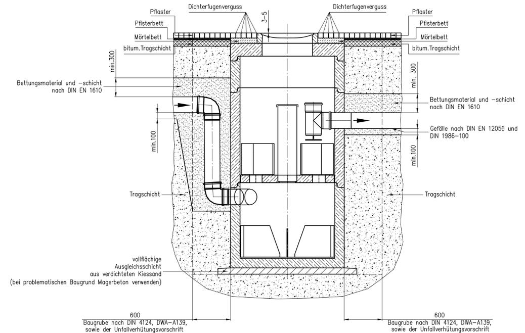
Die Tragschichten müssen frostsicher und gemäß RSTO (aktuelle Ausgabe) ausgeführt werden.
