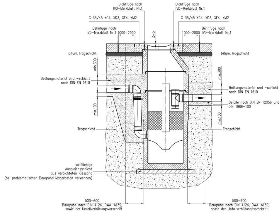
Die Tragschichten müssen frostsicher und gemäß RSTO (aktuelle Ausgabe) ausgeführt werden.
