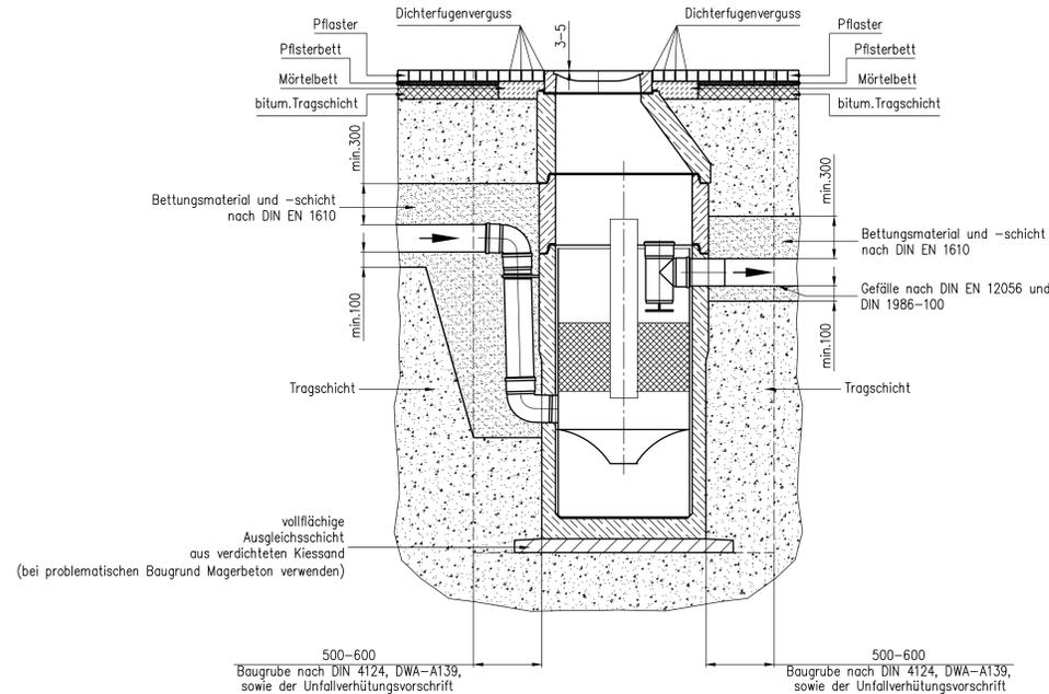
Die Tragschichten müssen frostsicher und gemäß RSTO (aktuelle Ausgabe) ausgeführt werden.
